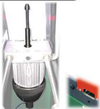
Dispositivo pneum. sostituzione rapida gruppo frese Pneumatische Fräser-Schnellwechsellvorrichtung
