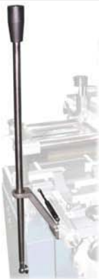
Avanzamento manuale testa foratura Manuelle Vorschub des Bohrkopfes
