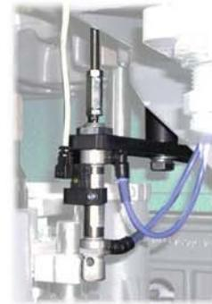
ARP : dispositivo supplementare per riconoscimento profili
