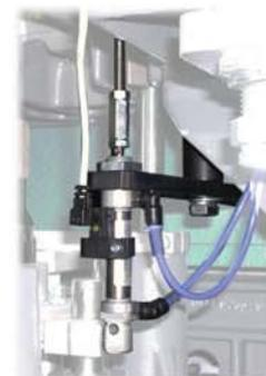
ARP : dispositivo supplementare per riconoscimento profili
