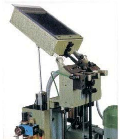
△ Bewährte automatische Schraubenzufuhr
